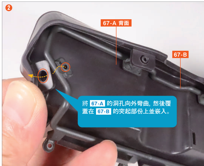
將左側的 67-B 突起部份對準 67-A 的洞孔並嵌入。
